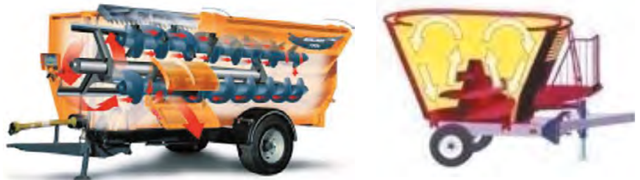
Рис. 2. Кормороздавач-змішувач Trioliet Solomix (Нідерланди) із стороннім завантаженням компонентів кормосуміші
