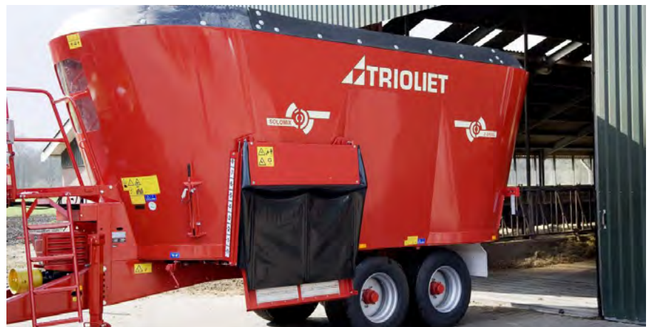
Рис. 2. Кормороздавач-змішувач Trioliet Solomix (Нідерланди) із стороннім завантаженням компонентів кормосуміші
