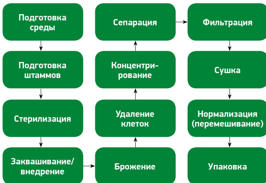
Рисунок 2. Схема технологического процесса производства МЭК «Натузим»
