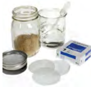
Рис. 1. Банка Мейсона, фільтрувальний папір, розчинник
