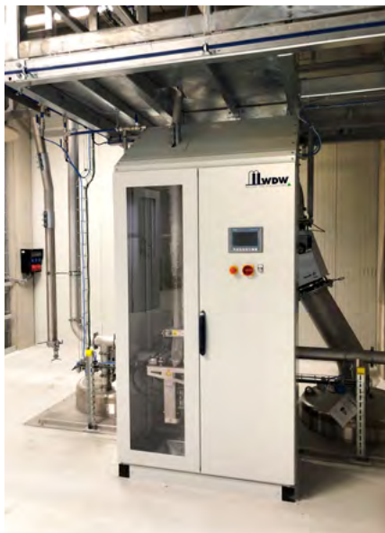
Рис. 4. «Карусель» M18 для отбора проб
