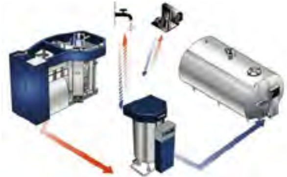
Рис. 3. Схема миттєвого охолодження молока
