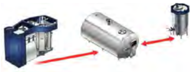
Рис. 4. Схема охолодження молока з використанням буферної ємності
